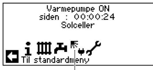
Så snart egenstrøm benyttes for varmtvann hhv. varmtvannsberedningen, vises dette i navigasjonsskjermen:
